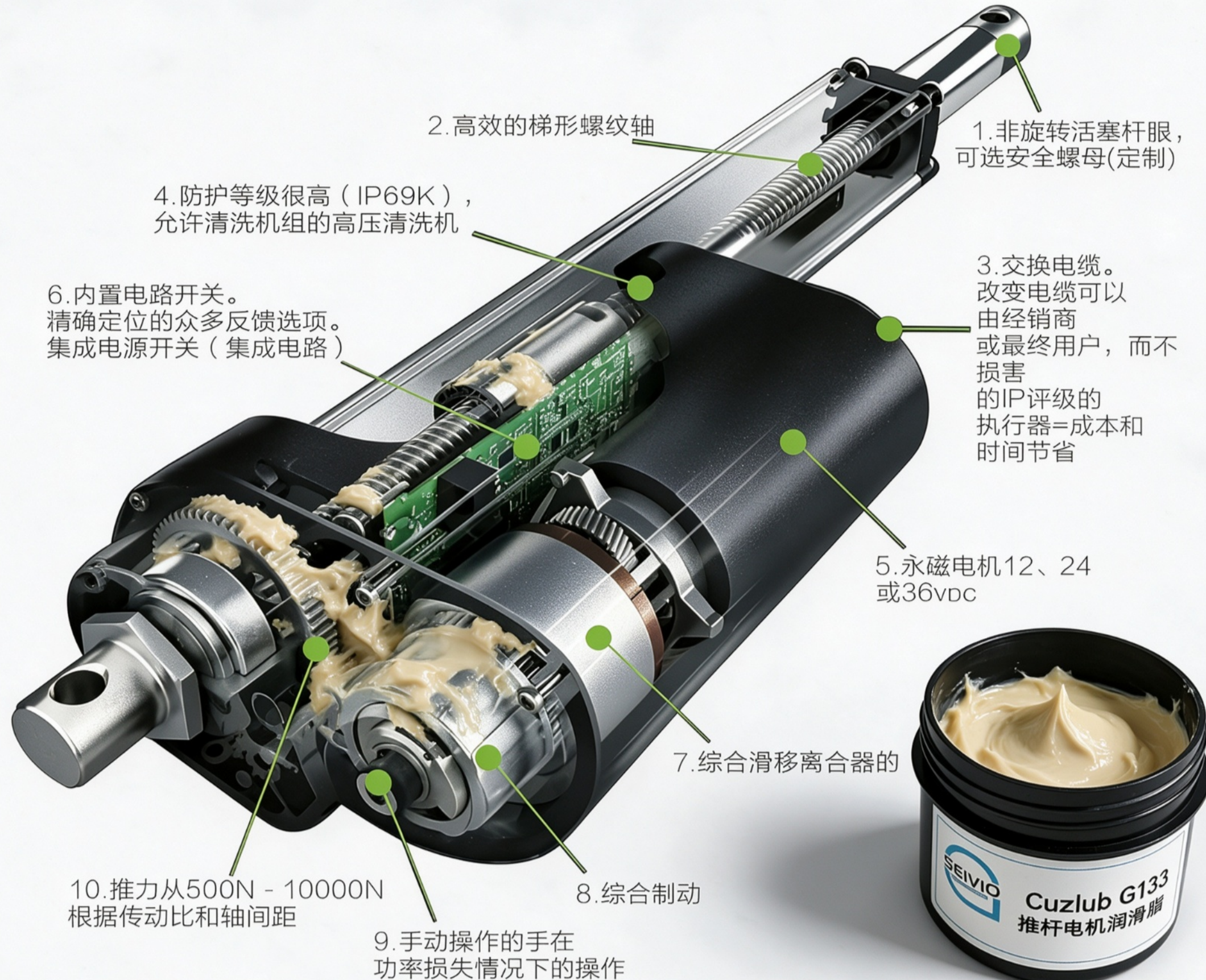
电动推杆结构剖视：Cusclub G133 作用于齿轮、梯形丝杆、蜗轮蜗杆等核心摩擦部位
